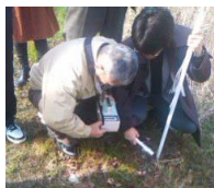
放射線測定として使ったのは、ガンマ線を測定する「シンチレーション サーベイ メーター」
