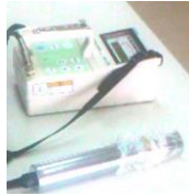
放射線測定として使ったのは、ガンマ線を測定する「シンチレーション サーベイ メーター」
